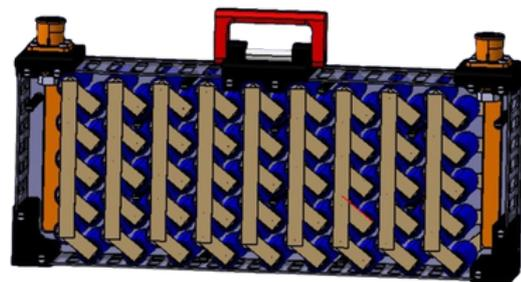
Pour commencer voici les spécifications de notre pack batterie : sa structure est en 5p18s (5 cellules en parallèle et 18 en séries par segment) avec une tension nominale de 453.6V et un courant de décharge de 175 A.
