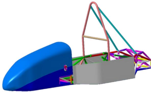
Pour étudier ces différentes pièces, nous avons utilisé Ansys pour simuler la rigidité du châssis et des pièces de fixation, et Simscale pour observer l'écoulement de l'air sur la carrosserie. Nous les remercions pour leur partenariat et leur soutien.
